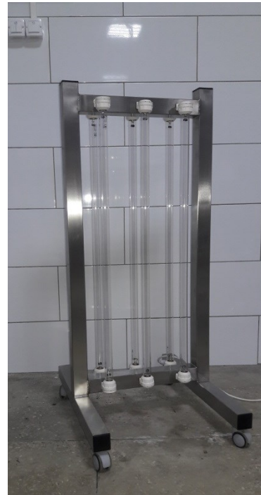
Малюнок 6. Бактерицидні опромінювачі з неекранованими УФ лампами серії ОБП
