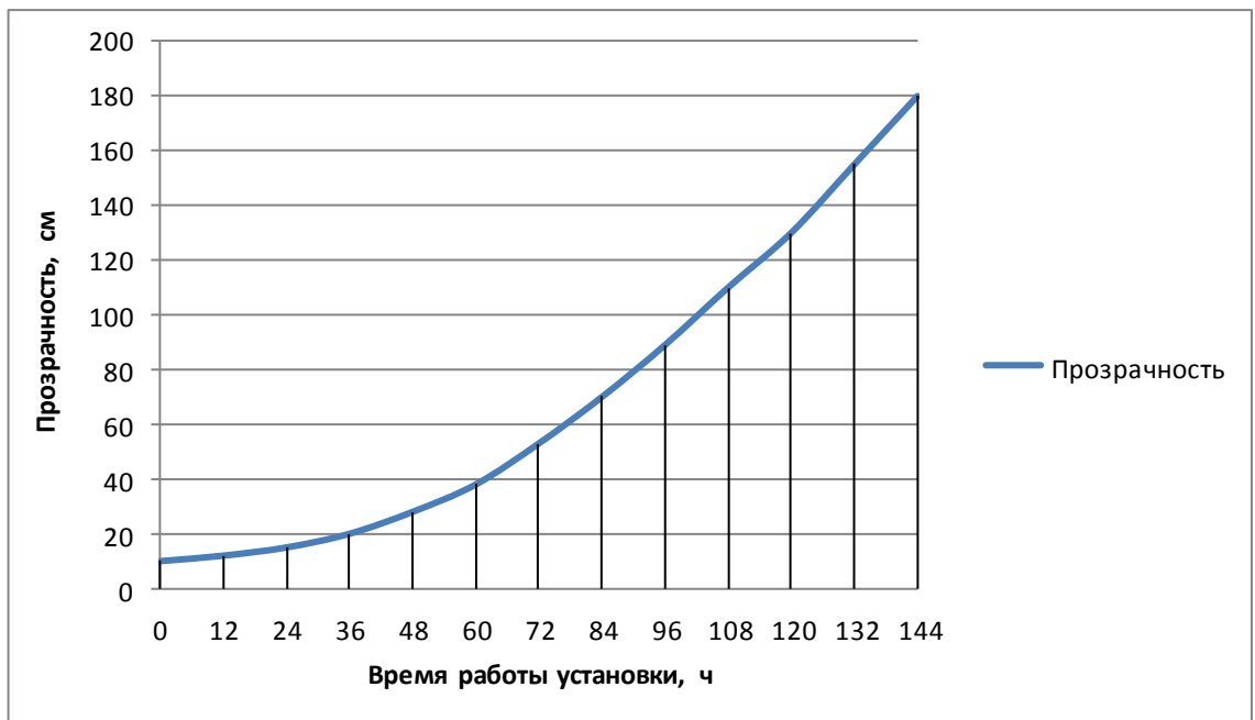
Рис. 2 – Зависимость прозрачности воды в водоёме от времени работы установки.
