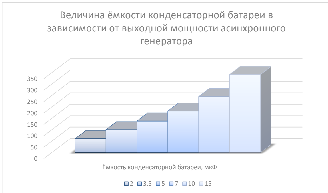
Рис. 3. Величина ёмкости конденсаторной батареи, необходимой для возбуждения асинхронного генератора.
