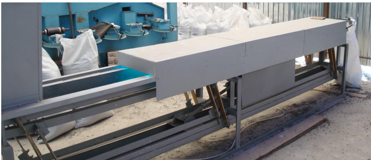
Рис. 1. Прототип первого полупромышленного УФ активатора семян.
