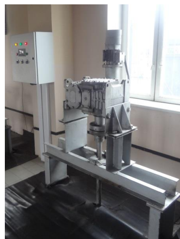
Рис.6. Система регулювання та підтримки рівня води у каналі
