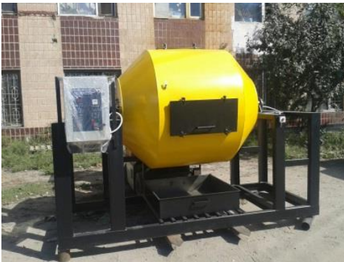
Рис. 1. УФ активатор барабанного типа ОБП09.1Т10 производительностью до 500 кг/ч.
