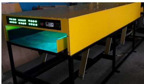
Рис. 2. Установка ОБП10К.2430АС конвейерного типа производительностью до 1000 кг семян в час.
