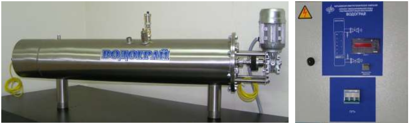
Рис. 2. УФ установка з лампами низького тиску та вбудованою автоматичною системою очищення кварцових чохлаів. Продуктивність 10 м 3 /годину, потужність 0,12 кВт. Питомі витрати електроенергії – 12 Вт/м 3 .
