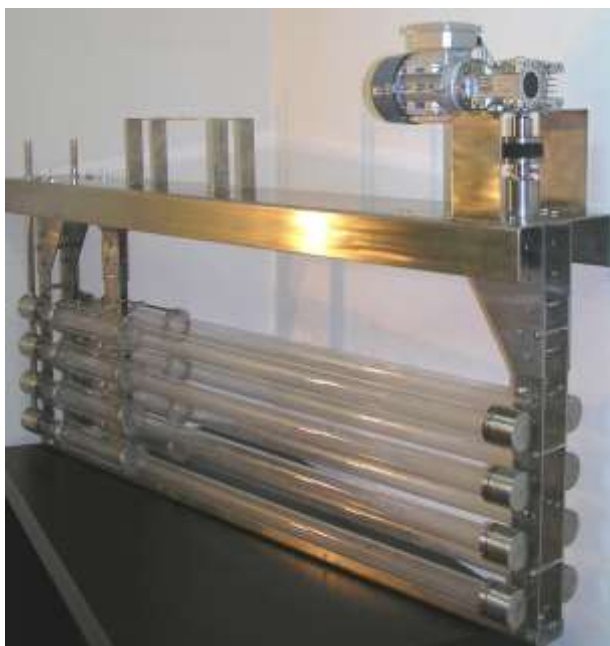
Рис. 5. Знезаражуюча касета В8КС.01 з амальгамними УФ лампами та вбудованим механізмом очищення кварцових чохлаів
